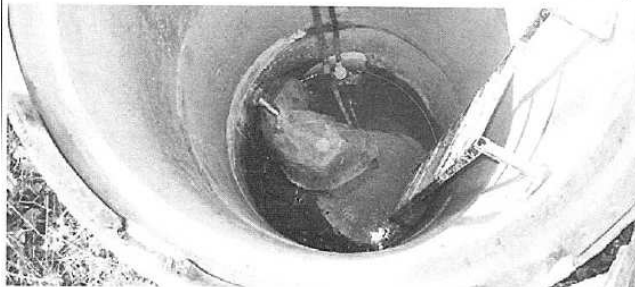
Vue du lysimètre et de son système de collecte d'eau
